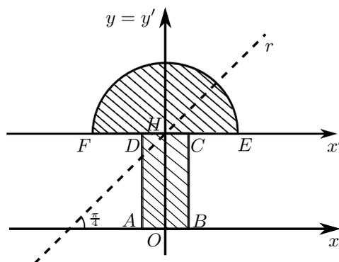
ESERCIZIO 2. In un piano verticale  $Oxy$  si consideri un'asta omogenea  $AB$ , di massa  $m$  e lunghezza  $2L$ , vincolata a passare senza attrito per il punto fisso  $D$  di coordinate  $(0, d)$ , ( $d > 0$ ). Oltre alla forza peso, sull'asta agisce una molla ideale di costante elastica  $k = \frac{9\sqrt{3} mg}{16 L}$ , che collega  $A$  con  $D$  e una forza costante applicata in  $B$ ,  $\vec{F}_B = \frac{mg}{4} \vec{j}$ .
