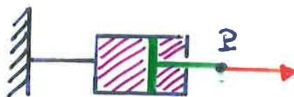
b) **FORZA IDRAULICA** (f. resistente di tipo idraulico)
