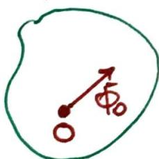
Il vincolo punto fisso si schematizza con una reazione  $\bar{\Phi}$  applicata in O di direzione arbitraria
