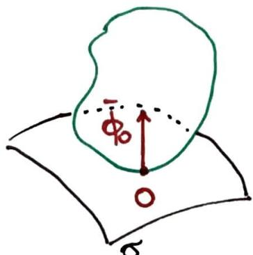
Il vincolo appoggio si realizza mediante un'unica reazione  $\bar{\Phi}$  applicata in O:
