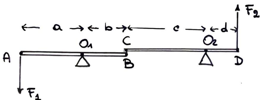
L'asta AB esercita sull'asta CD una reazione  $\vec{\phi}_B$  e l'asta CD esercita su AB una reazione  $\vec{\phi}_C$ .
